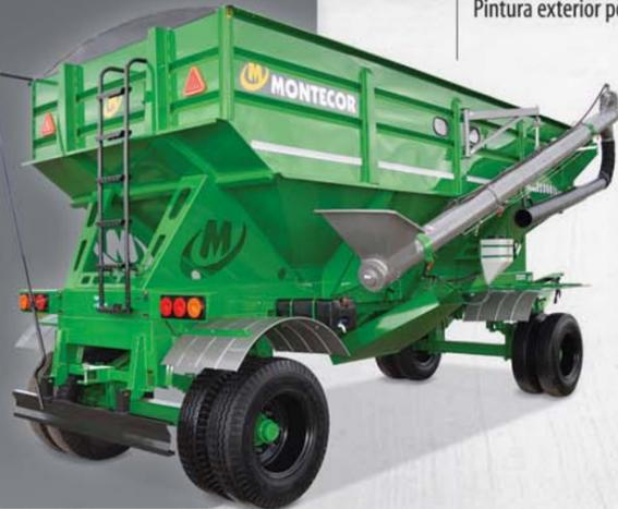
Diseño apto para el transporte, carga y descarga de semillas y fertilizantes.
