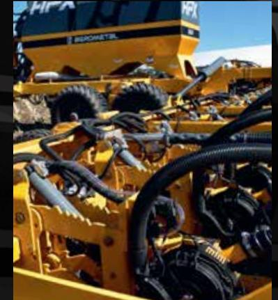
Actuador de doble cámara, una neumática de presión regulable que imprime una fuerza constante sobre el cuerpo de siembra. A diferencia de sistemas similares, el TWIN FORCE cuenta con otra cámara hidráulica que otorga amortiguación controlando y estabilizando oscilaciones del cuerpo de siembra. Esto permite sembrar en terrenos desparejos y en cualquier condición un 25% más rápido (\*).
